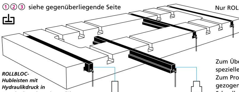
Nur ROLLBLOC-Wälzleisten sind für den 'Überkopfeinsatz' geeignet.
