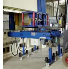
Beladen der Konsole zum Werkzeugwechsel
