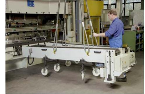
Transport der Konsolen mittels Hallenkran oder auf den Rollen
