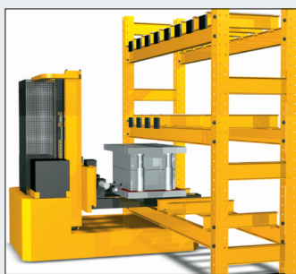
Direkteinlagerung. Für das Abstellen großer Werkzeuge wird das DILOS Universal-Regal unterfahren
