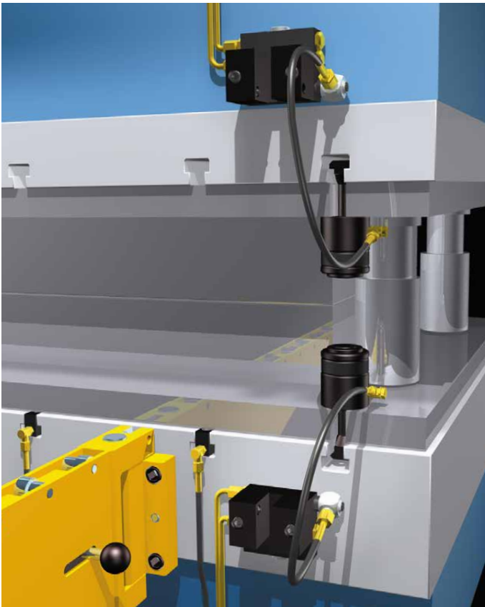
Beim Einsatz von ROLLBLOC-Hohlkolbenspannern kann die Pressentischfläche vollformatig für die Werkzeugplatte genutzt werden
