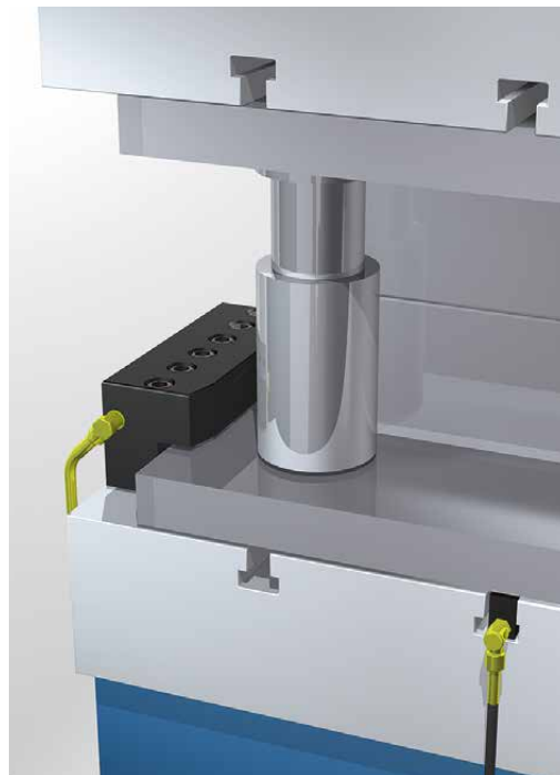
Bei ROLLBLOC-Spannleisten wird der Spanndruck durch gereigte Hydraulik-Spannzylinder erzeugt. Drei Ausführungen mit 3, 5 und 8 Zylindern stehen standardmäßig zur Verfügung
