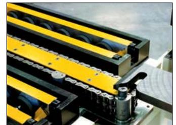
*Automatik-Kupplung mit werkzeugseitigem Kupplungshaken*
