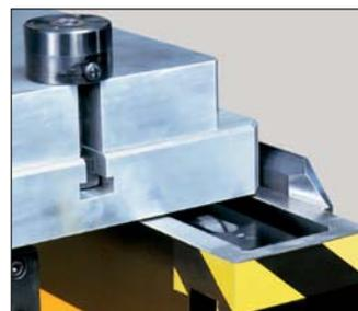
Die Seitenführung wird für das Wechseln gleichformatiger Werkzeuge bzw. beim Arbeiten mit Wechselplatten eingesetzt
