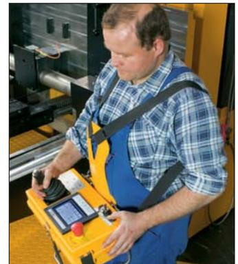
Mit dem Joystick kann der Bediener alle Funktionen feinfühlig steuern. Auf dem Display werden u. a. die Radstellungen angezeigt.
