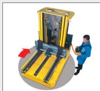
*In Kreisfahrstellung kann der DILOS TRUCK mit seiner Allradlenkung auf der Stelle drehen und wenden*
