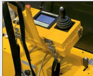
*Tragbares Bedienpanel für optimalen Bedienkomfort. Zentrale Kontrolle aller Funktionen beim Fahren und beim Werkzeugwechsel*
