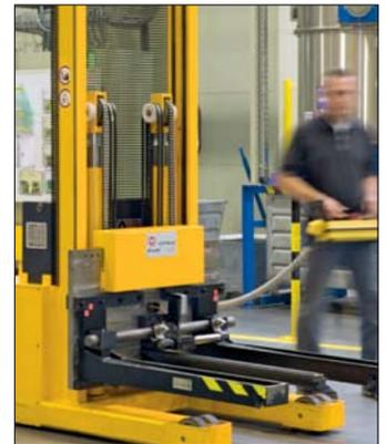
*Für die Transportfahrt wird die beladene Gabel aus Sicherheitsgründen auf Fahrgestellhöhe abgesenkt. Automatisch geregelte Schleichfahrt bei angehobener Traggabel*
