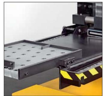
*Zubehör; Integriertes Tableau mit Tragkugeln zum Wechseln kleiner Modulwerkzeuge*
