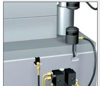
*Anwendungsbeispiel: ROLLBLOC-Hohlkolbenspanner HK mit Hydraulikanschluss an die ROLLBLOC-Parkstation PH*
