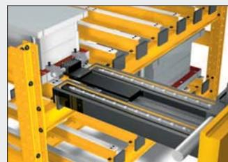
*Die Weite der Werkzeugtraggabel und die Weite der Gleit-Tragleisten werden aufeinander abgestimmt*
