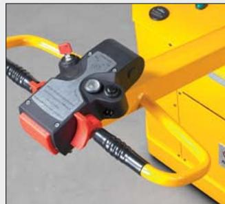
*Lenkdeichsel mit Fahrregler für einfache Bedienung. Standard bei DILOS BUGGY*
