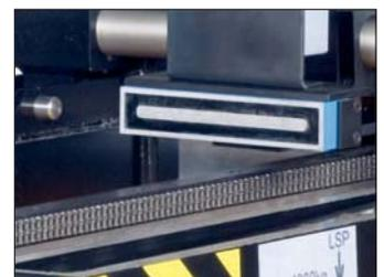
*Schnelle Magnetkupplung. Werkzeugwechsel ohne manuellen Eingriff*
