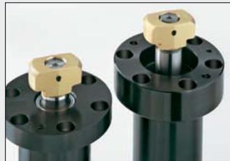
*Rechnergesteuerte DILOS Schwenk-Zugspanner für Pressentisch und Stößel*
