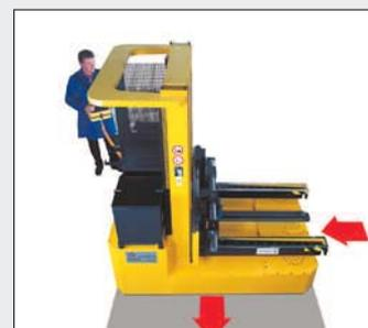
*Ohne zusätzliches Fahrmanöver kann zwischen Quer- und Längsfahrt gewechselt werden. Die DILOS Allradlenkung macht sorgfältige und zügige Fahrmanöver mit schweren Pressenwerkzeugen möglich*
