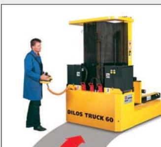
*Allradlenkung im 'Normalbetrieb'. Bei dieser Bahnfahrt wird nur das Hinterrad gelenkt*
