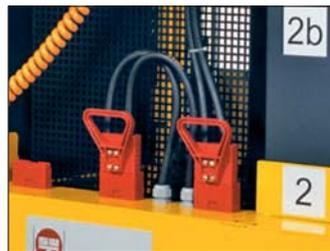
*Steckerkupplungen für schnellen Batterieanschluss bzw. Batterie-trennung*
