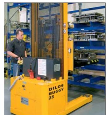
DILOS BUGGY 25 SPECIAL mit Bedienpanel und Querverschiebung des Gabelschlittens
