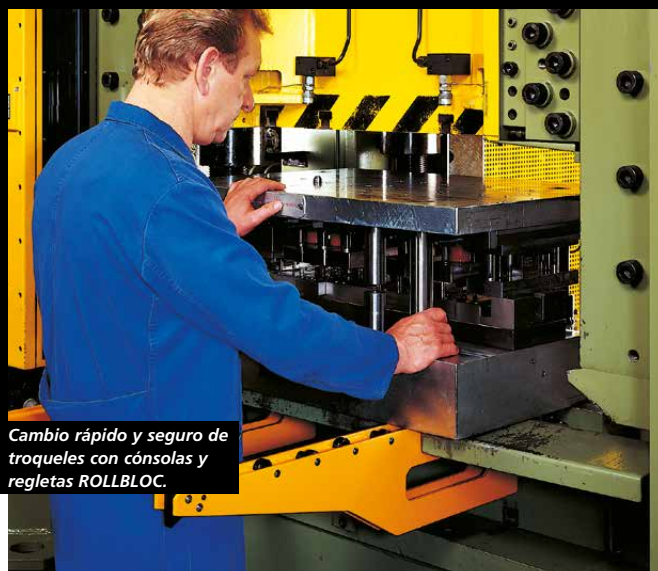
Transferencia rápida y segura de los troqueles entre el ROLLBLOC-BUGGY y la prensa de la mesa, equipada con regletas ROLLBLOC.
