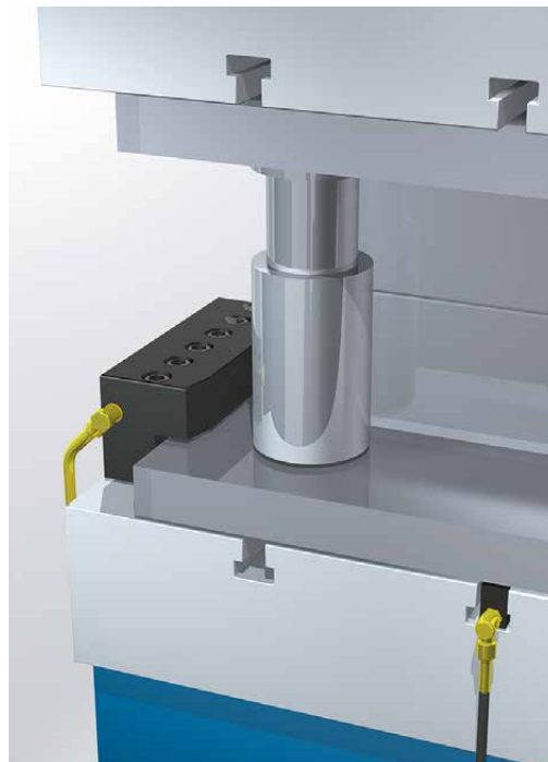
En las regletas de sujeción ROLLBLOC la presión de sujeción es generada por cilindros hidráulicos en línea. Se dispone como estándar de tres ejecuciones con 3, 5, y 8 cilindros
